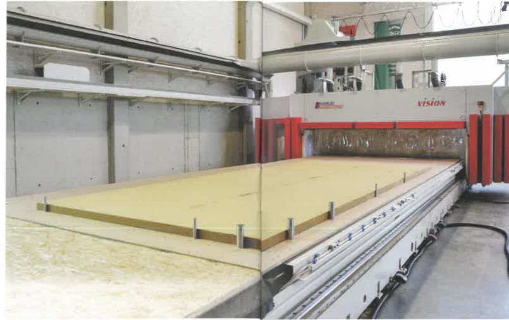
Bearbeitungstisch mit spezieller Tischverlängerung und Anschlägen.
