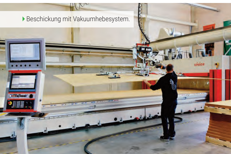
► Plattenbearbeitung mit Sägeschnitt.
